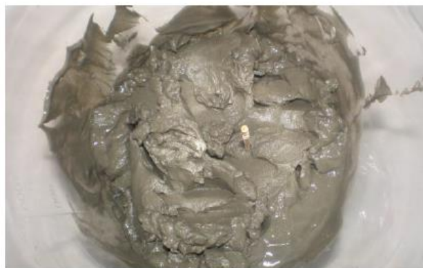
4. セメントスラリーを添加後、攪拌2分後
